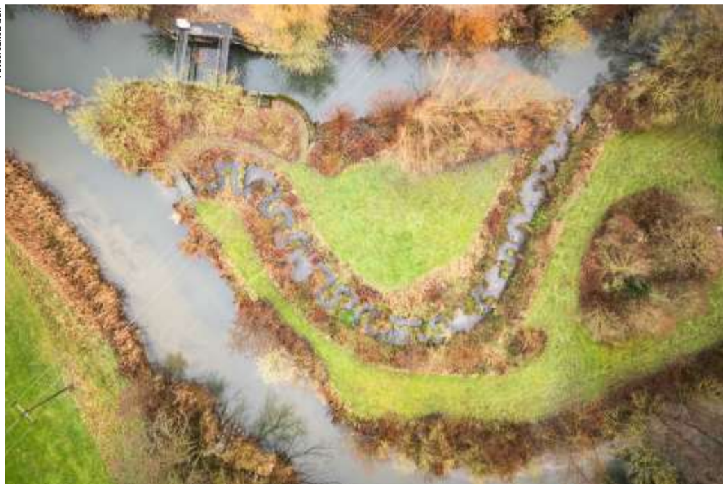
Durch die Fischtrepp wandern die Fische, an Wehr und Kraftwerk vorbei, flussaufwärts in der Itz.
